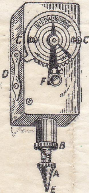
1. Das Werk an den beiden Knöpfen C bis zum Anschlag aufziehen und durch den kleinen an der Schmalseite befindlichen Hebel D abstellen.
